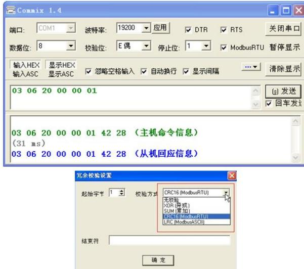
在以上示例中，将“端口”设置为“COM1”。“波特率”的取值要与 P14.01 的设置一致；“数据位”、“校验位”、“停止位”的取值与 P14.02 的设置一致。因使用 RTU 模式，必须选择“输入 HEX”和“显示 HEX”。为实现自动 CRC 校验，必须勾选 “ModbusRTU”，且在“冗余校验设置”中设置“起始字节”为“1”，选择“CRC16(ModbusRTU)”。一旦使能自动 CRC 校验，在填写指令时不能填写 CRC，否则会因重复导致指令错误。
