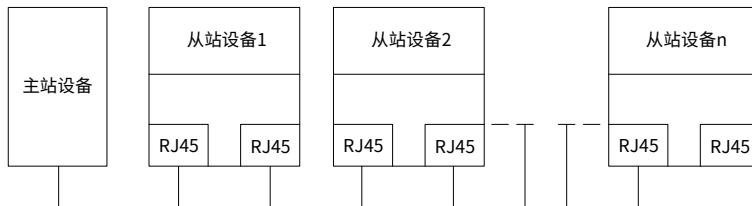
图 E-9 星型网络拓扑电气连接
